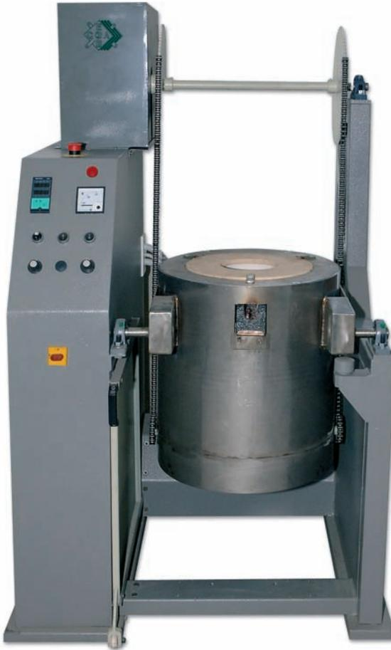
*macchina* adoperata nell'industria orafa per fusione metalli nobili a temperatura massima 1200° con scarico meccanico e a ribaltamento.
