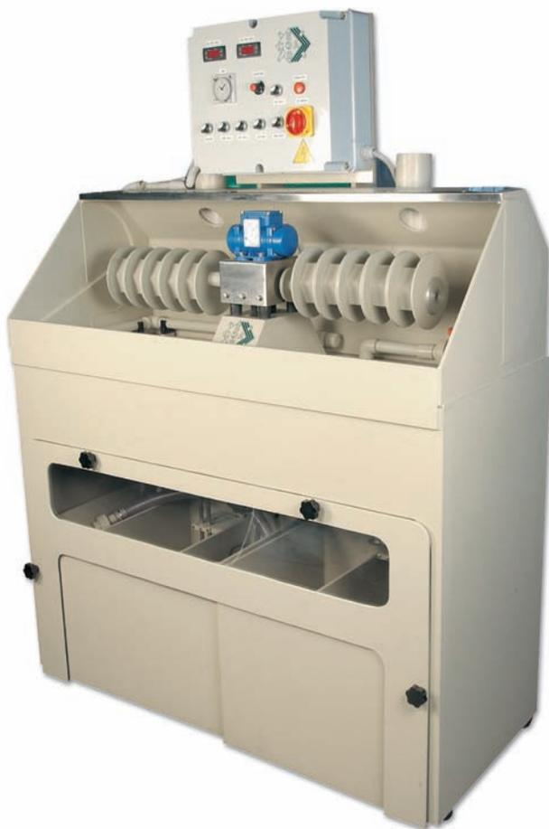
*macchina adoperata nel settore orafico per il lavaggio della catena (AU-AG) dopo essere stata sottoposta a saldatura.*
