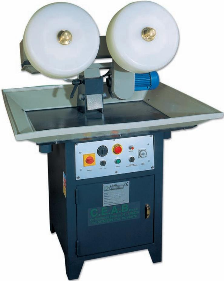
*macchina utilizzata per talcare la catena prima di effettuare la saldatura.*
