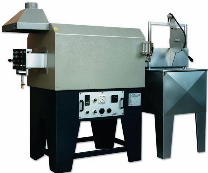
*macchina realizzata per la rimozione degli ossidi superficiali generatisi nel corso delle lavorazioni cui i manufatti sono stati sottoposti.*
