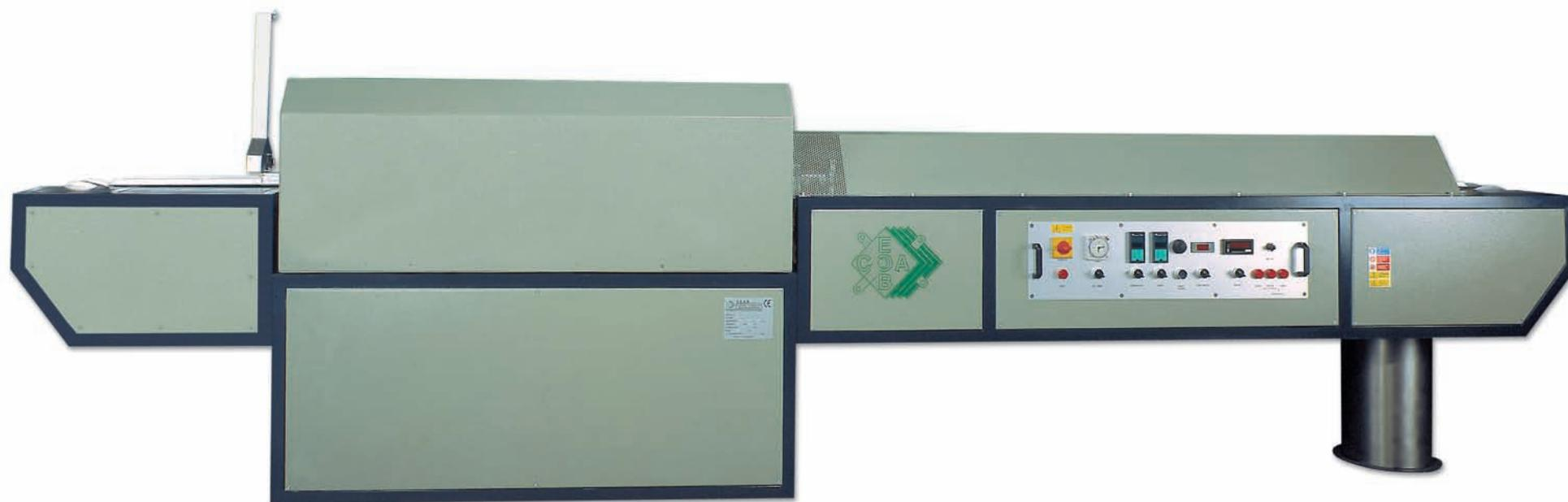
*macchina utilizzata per la saldatura di catene vuote o piene e oggetti vari.*
